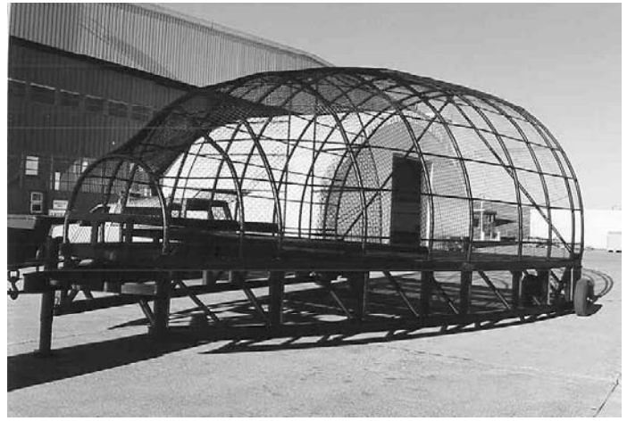
Jig/frame for Swissair MD-11 3-D mockup (photo courtesy TSB Canada).
