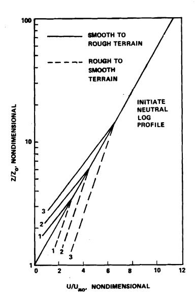
FIGURE 4. SCHEMATIC DIAGRAM OF THE VARIATION IN THE LOGARITHMIC WIND PROFILE DUE TO A DISCONTINUITY IN SURFACE ROUGH-NESS. THE NUMBERS DENOTE THE SEQUENCE OF EVENTS FOLLOWING THE MEAN FLOW DOWNSTREAM FROM THE SURFACE ROUGHNESS DISCONTINUITY. U, AND Z<sub>O</sub> DENOTE THE UPSTREAM SURFACE FRIGTION VELOCITY AND ROUGHNESS.
