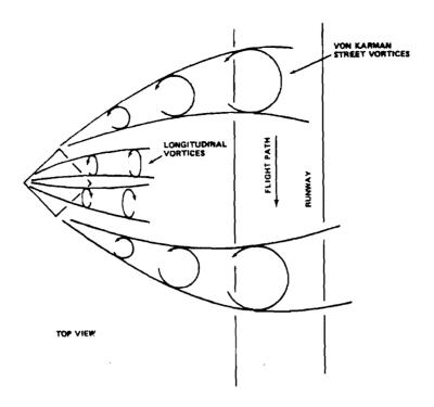
FIGURE 20. CROSSWIND FLIGHT PATHS THROUGH VORTICES
