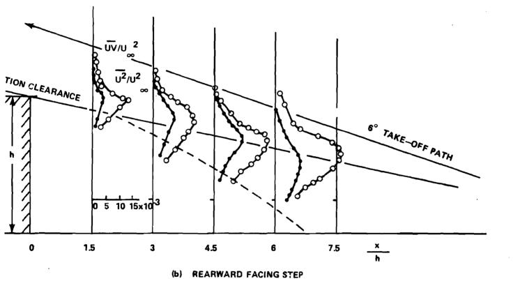
FIGURE 12.b. GUST INTENSITY AS A FUNCTION OF POSITION DOWNSTREAM OF A REARWARD FACING STEP AND THE TAKE-OFF FLIGHT PATH OF AN AERONAUTICAL SYSTEM.
