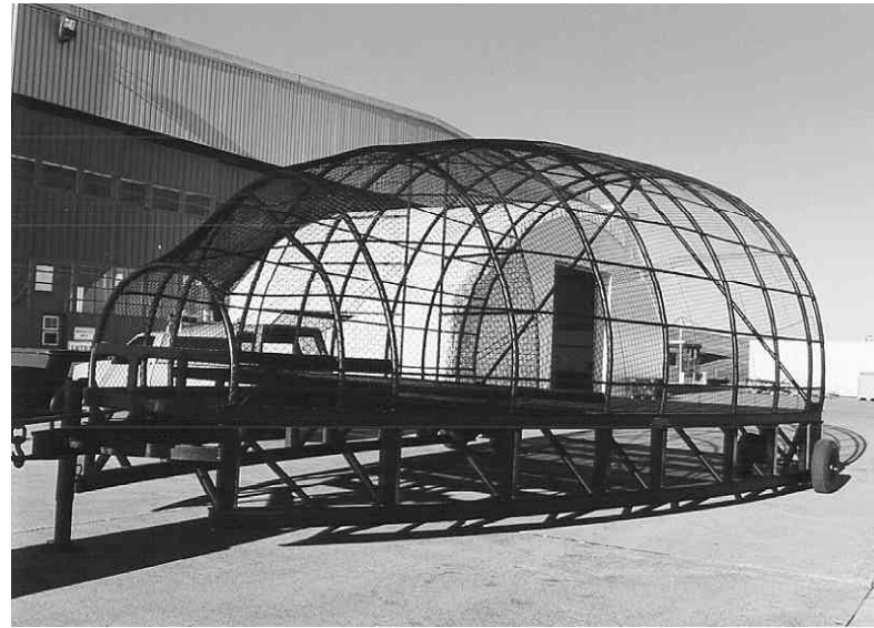
Jig/frame for Swissair MD-11 3-D mockup (photo courtesy TSB Canada).
